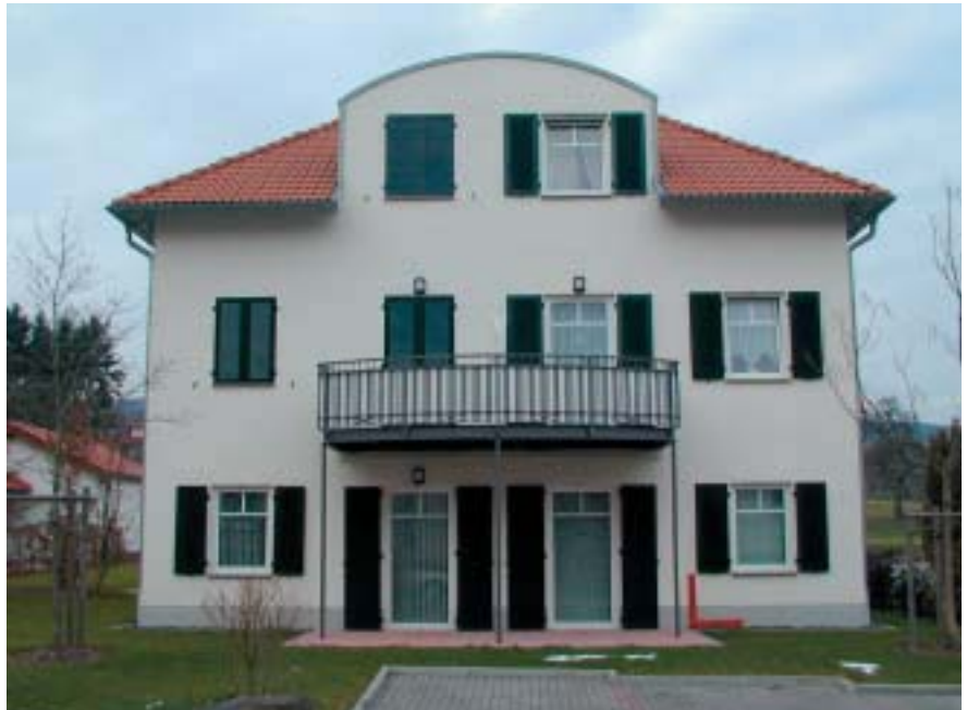
Das Originalbild von der Digitalkamera. Es enthält alle aufnahmebedingten Fehler wie Bildfeldwölbung (Weitwinkelleffekt, der von der Kamera verursacht wird) und Fluchtpunktperspektive (Verzerrung, die durch den Aufnahmestandpunkt hervorgerufen wird).
