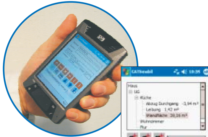
Bild oben: Aufmaßfassung auf der Baustelle in den Pocket-PC.
