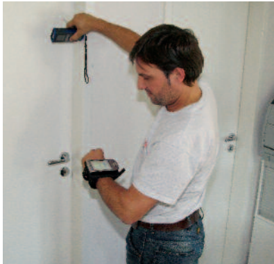
2 Mit dem Lasermessgerät in der Hand und dem Computer am Handgelenk demonstriert Patrick Dörfling die Arbeitsweise des mobilen Aufmaßes. (Fotos: Dolt)
